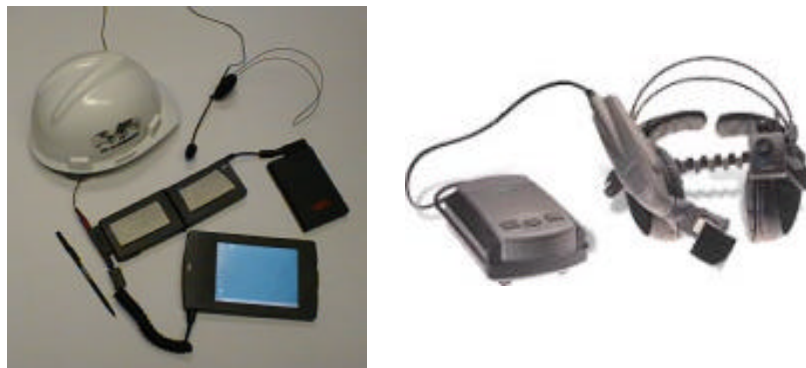
Abb. 1: Wearable Computer der Firmen VIA (links, mit handgehaltenem Display) und Xybernaut (rechts, mit kopfgetragenen Display)
